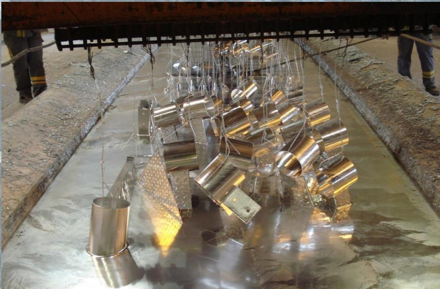
Contrairement à la peinture, Le procédé de galvanisation se fait par l'immersion de la pièce à galvaniser dans un bain de Zinc en fusion. Cette méthode permet d'assurer la protection de la surface total de la pièce quelque soit sa forme géométrique.
